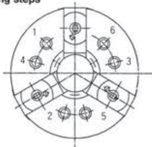
Fig. 8 ボルト締付手順 Bolt tightening steps
